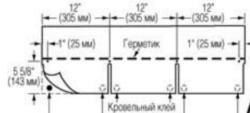
Отступить от каждого углового края 1" (25 мм) и нанести битумный клей небольшим количеством. Отмерить от точек нанесения клея 1 и 2 около 12" (305 мм) и нанести еще битумный клей в двух местах.
