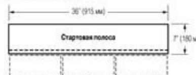
Отрезать 6" (152 мм) только от левого края первой стартовой полосы. Установить оставшуюся полосу длиной 30" (762 мм) на нижний левый угол крыши. (См. рис. А).
